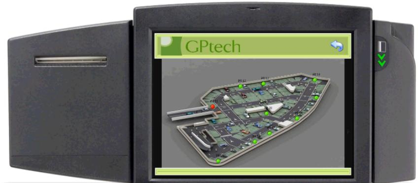
GPtech ha diseñado un Software de Gestión de demanda a nivel de Gestor Local (GL) aplicado a un Parking Privado que permite la función "Vehicle to grid" (V2G)
